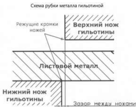
Рисунок 1 – Схема рубки металла гильотиной
